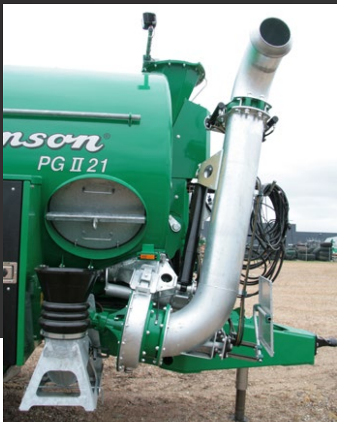
Et-leddet SAP-arm (SAP 1 Mk 2) med pumpe.
