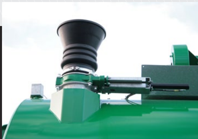
Påfyldning fra ekstern pumpe via fleksibel 10" gummi fyldetragt.
