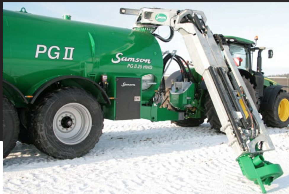
Pumpetårn med teleskoparm.
