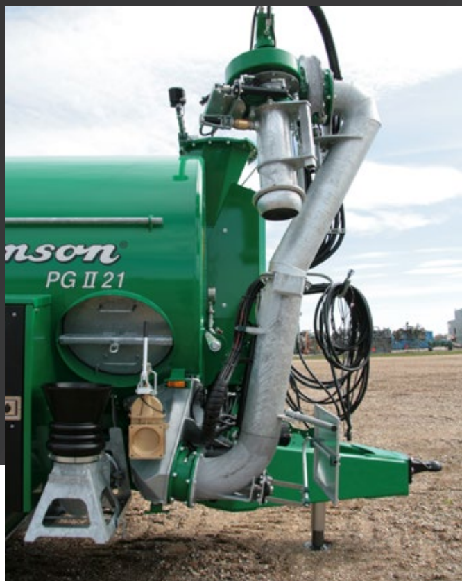
To-leddet SAP-arm (SAP 2) – med eller uden pumpe.
